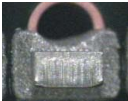
Bild 8: Der PIP + Prozess: das Lotteil wurde in die bereits aufgedruckte Lotpaste (PIP) bestückt
