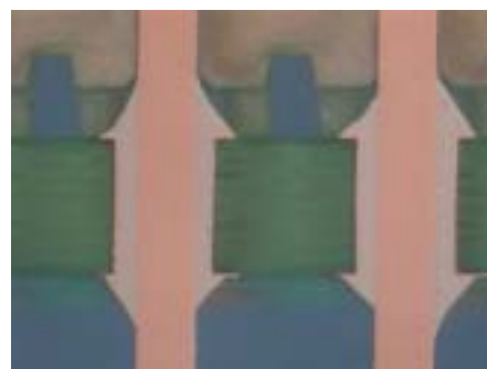
Bild 1: Pin-in-Paste-Lötstelle mit zusätzlicher Lot-Preform
