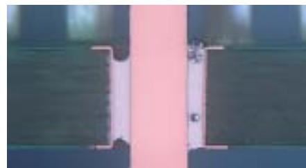
Bild 2: Pin-in-Paste-Lötstelle ohne zusätzlicher Lot-Preform
