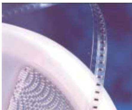
Bild 7: Vorgefertigte 0603-Lotteile in Bestückungsrolle
