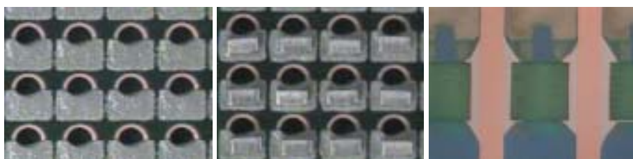
Bild 9: Abfolge der einzelnen PIP + Prozessschritte
