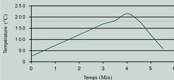
Ce profil est conçu pour être utilisé avec Sn63/Pb37 et Sn62/Pb36/Ag2. Il servira de consigne générale pour définir un profil de refusion pour l'utilisation avec d'autres alliages. Il peut être nécessaire d'ajuster ce profil en fonction des exigences spécifiques de procédé.
