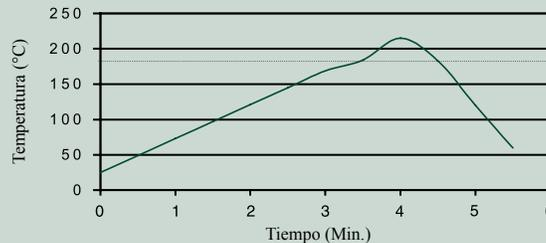
Este perfil está diseñado para el uso de Sn63/Pb37 y Sn62/Pb36/Ag2, y puede servir como una guía general para establecer el perfil de reflujo para el uso de otras aleaciones. Pueden ser necesarios algunos ajustes a este perfil, con base a requerimientos específicos del proceso.
