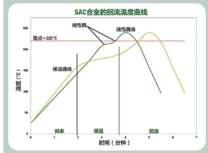
表中推荐的曲线适用于大多数SnAgCu(SAC)的无铅合金，包括SAC305(96.5%锡/3%银/0.5%铜)。使用Indium8.9HFC焊锡膏时，上表可作为确定回流曲线的一般性参考。根据特定的工艺要求，包括基板大小、厚度和密度，对曲线做出改动是可行的，也可能是必要的。从线性曲线开始，然后根据需要移至可选的保温曲线。线性曲线中的水平保温区间(线性波峰)也可以被移除。
