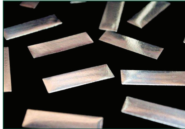
在Sn63上LV助焊剂涂料与NC-9的对比
